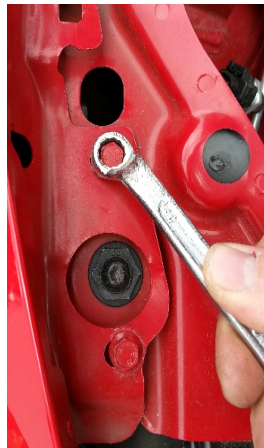
Schraube mit M10 Ring-Schlüssel lösen.
