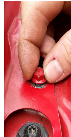
Schraube nachdem lockern, mit den Finger heraus drehen.
