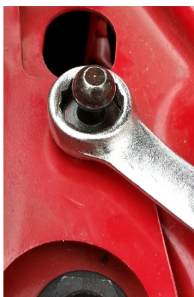
... und mit einem Ring-Schlüssel M13 handfest festziehen.
